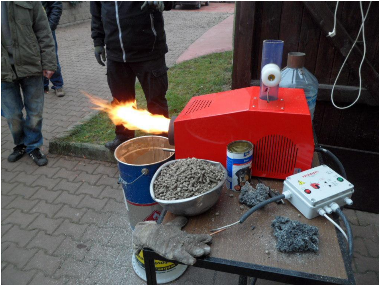
Kuva 2. Petrojet H15-poltin demonstraation kohteena, kun sillä poltetaan pellettejä.
